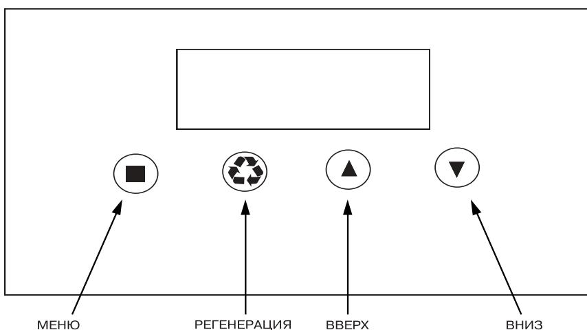
Дисплей отображает в течение 5 сек. текущую дату и время, затем прокручивает по очереди информацию о работе фильтра. Для быстрой смены сообщений используйте кнопку ВВЕРХ или ВНИЗ.
